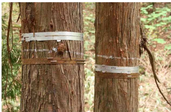
写真6-1-1-1 アルミ製デンドロメータ (上) とプラスチック製デンドロメータ
