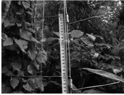
写真 3-2-1 最深積雪深観測用のワイヤーに設置したアルミ線
