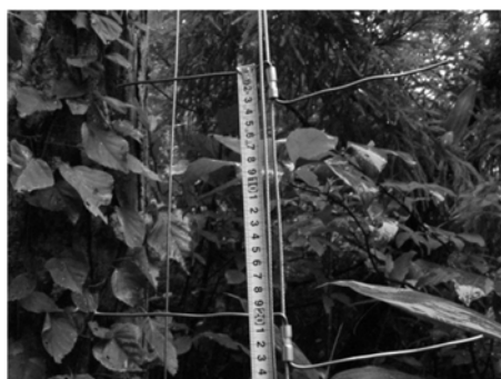
写真 3.2.1 最深積雪深観測用の ワイヤーに設置したアルミ線
