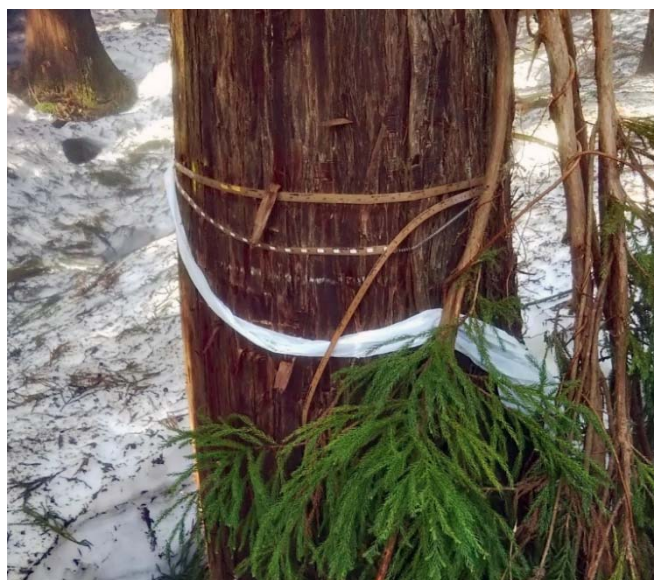
写真 6-1-3-1 除雪時の投雪によるダメージを受けたデンドロメータ (2019 年 4 月 22 日)
